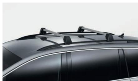
Ces barres de toit servent de base à tous les autres systèmes porteurs. Elles se fixent vite et facilement sur les rampes de pavillon. Un verrouillage antivol les préserve des mains indelicates.
