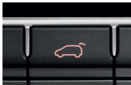
Le hayon motorisé s'ouvre électriquement depuis le siège conducteur ou à l'aide de la clé à radiofréquence. Il se ferme de lui-même lorsqu'on appuie sur la touche intégrée au hayon. En option
