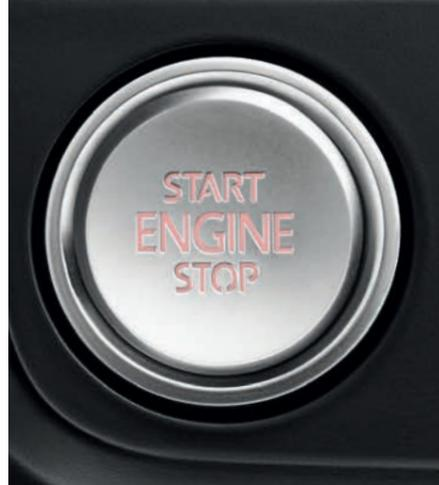
Un maximum de confort: voilà ce que vous procure le système de verrouillage et démarrage sans clé 'Keyless Access'. Une technique de transmission et de sécurité perfectionnée vous permet d'ouvrir et de fermer le véhicule sans utilisation active de la clé. Pour démarrer ou arrêter le moteur, il suffit d'appuyer sur un bouton. En option
