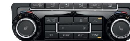
La climatisation 'Climatronic' avec détecteur de buée est dotée d'une régulation de température séparée pour les trois zones de l'habitacle avec diffuseurs d'air à l'avant mais aussi sur la 2<sup>e</sup> et 3<sup>e</sup> rangée de sièges. De série
