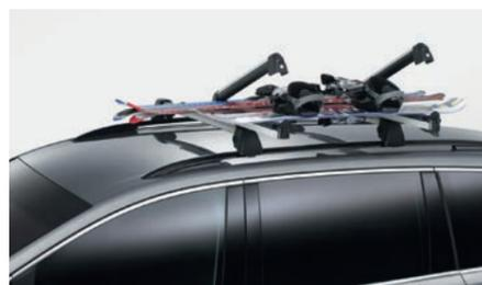
Le porte-skis et snowboards transporte de façon sûre et confortable jusqu'à six paires de skis ou quatre snowboards et peut aussi, grâce à ses grandes touches d'ouverture, être utilisé avec des gants. Un système télescopique facilite chargement et déchargement.
