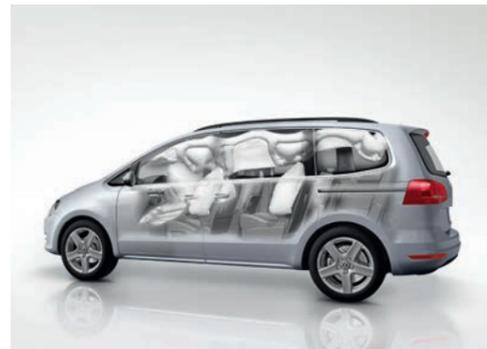
↑ Des Airbags frontaux et latéraux pour le conducteur et le passager avant ainsi que des Airbags de tête dans toutes les rangées de sièges assurent la protection des occupants de la voiture. S'y ajoute un Airbag de genoux côté conducteur. En cas d'accident, les Airbags se déclenchent et sont gonflés par un générateur de gaz en quelques millièmes de seconde.
