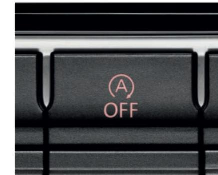
Le système 'Start-Stop'<sup>3</sup> vous aide à rouler de façon économique et peu polluante. Lors des arrêts à un feu rouge ou dans un embouteillage, il vous suffit de débrayer et de mettre la boîte au point mort ou d'appuyer sur le frein (avec boîte à double embrayage DSG) pour que le moteur s'éteigne automatiquement. De série
