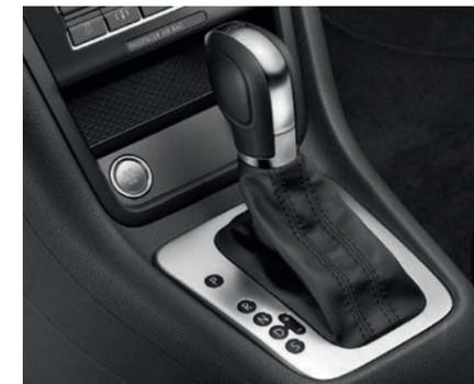
Une date dans l'histoire des boîtes de vitesses: la boîte à double embrayage DSG<sup>2</sup>. Cette boîte automatique passe le rapport suivant, déjà présélectionné, en quelques centièmes de seconde de façon presque imperceptible et sans interruption de motricité.
