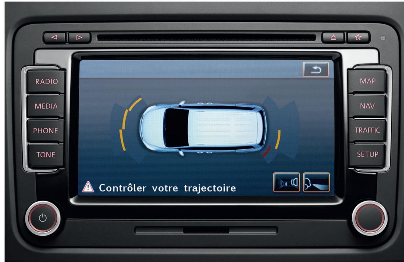
Renseigné par des capteurs dans les pare-chocs avant et arrière, l'aide au stationnement avant et arrière vous prévient à l'aide de signaux sonores des obstacles éventuels lors des manoeuvres de stationnement. Plus l'obstacle est proche, plus les signaux deviennent rapides. En outre, la visualisation des obstacles sur les écrans des radios RCD 310 et 510 et des GPS RNS 315 et 510 est particulièrement utile.
