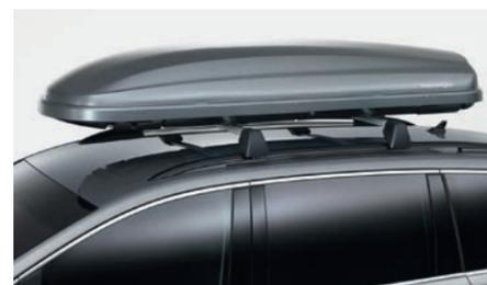
Le coffre de toit verrouillable existe en plusieurs volumes. Il se fixe facilement sur les barres de toit au moyen d'un système de verrouillage rapide et se charge et décharge confortablement des deux côtés.
