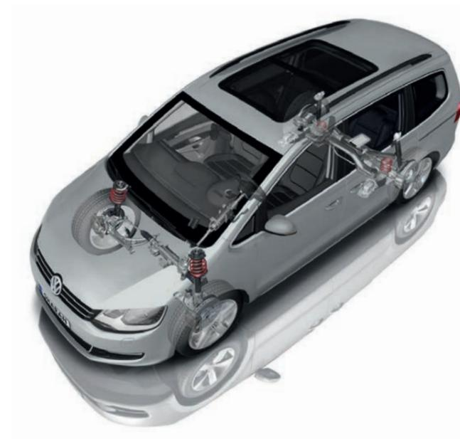
← La régulation adaptative de châssis DCC adapte en quelques millièmes de seconde chaque amortisseur à l'état de la route et à la conduite. Vous avez le choix entre trois variantes CONFORT, NORMAL et SPORT que vous sélectionnez en appuyant sur un bouton. En option
