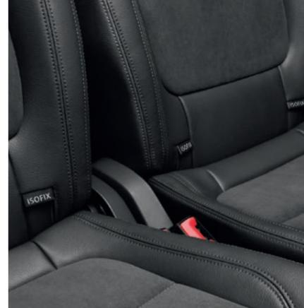
← La seconde rangée de sièges de série et la troisième en option sont équipées d'œilletons ISOFIX qui facilitent énormément l'installation de sièges enfants. Etant solidaires de la carrosserie, ces robustes fixations assurent un maximum de sécurité. De série
