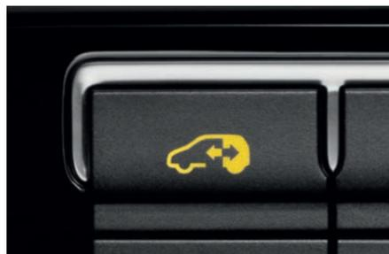
Particulièrement pratiques et sûres, les portes arrière coulissantes électriquement peuvent être commandées du tableau de bord, de la télécommande, par les poignées et se ferment grâce à un bouton logé sur le montant central. Un bip d'avertissement est émis pendant la manoeuvre et le moindre obstacle interrompt le coulissement. De série sur Carat.
