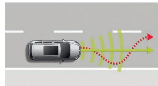
L'assistant de maintien de trajectoire 'Dynamic Lane Assist' attire l'attention du conducteur, au moyen d'une vibration dans le volant, lorsque le véhicule est susceptible de quitter sa trajectoire.
