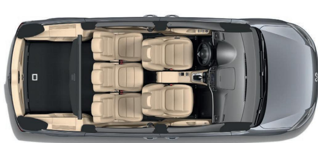
En variante 5 sièges, le Sharan possède un vaste coffre de 885 litres. Vous pouvez en outre rabattre les trois sièges arrière ainsi que le dossier<sup>1</sup> du siège passager avant afin de porter le volume du coffre à 2.430 litres. De série
