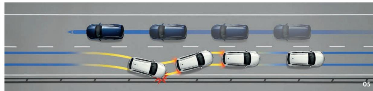
**03** L'assistant de maintien de voie 'Lane Assist' : à partir d'une vitesse de 65 km/h, une caméra peut percevoir si le véhicule quitte involontairement la voie tracée sur le sol. Une fois activé, le système émet des avertissements par le biais de vibrations ressenties dans le volant.\* de série sur Carat Edition
